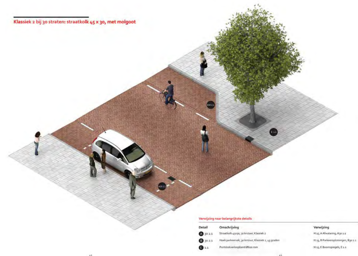
Figuur 3.1 Principedetail van de Puccinimethode voor 30 km/u straten.
