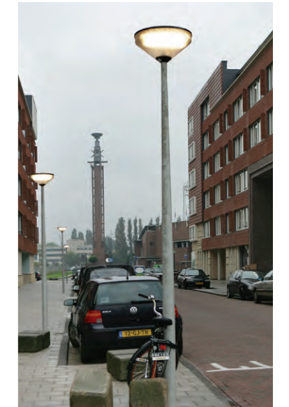
Fig. 3.13 Heel 30 km/h gebied: conische lichtmast 4m met Friso Kramerarmatuur (Lange Stammerdijk: geen uitzondering op dit type volgens beleidsplan verlichting)
