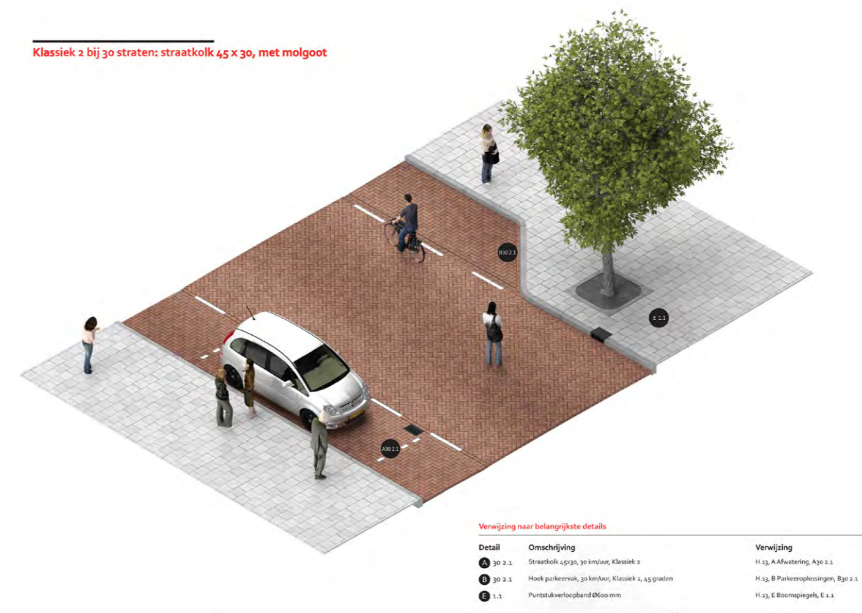
Fig 3.1 Principedetail van de Puccinimethode voor 30 km/u straten.
